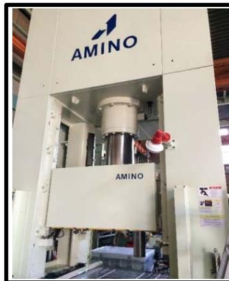
当社では、深絞りプレス専用機としてアミノ製の対向液圧成形機を2台保有していますが、今年初めに新たに3号機を導入し立ち上げ準備を進めてまいりました。仕様は総合出力400Mpaの能力を保有し、加工スペックは最大製品寸法は左右500mm×400mmまたは700mm×300mm最大製品深さは250mmまで加工できます。1号機は家電住宅専用。2号機は航空機製品で稼働が占められており、今回新たなお客様のニーズに応えるべく体制を整えました。絞り加工品の試作・量産を検討の方は加藤製作所にお任せ下さい。
