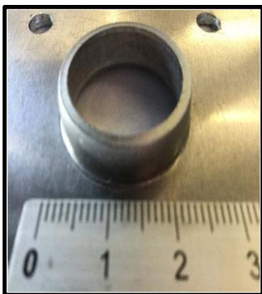
昨今、自動車部品の軽量化がテーマの展示会が開催されるなど注目度も高くなりました。当社でもアルミニウム材を使用してお引合を頂く機会が多くなり、そのひとつとしてオイルパンの軽量化がこれからの開発テーマと受け留めています。オイルパンとは車のエンジン下部に搭載される部品で、エンジンオイルを溜め外部に漏らさない役割を担っています。当社では鉄からアルミニウムに変える際に在る多くの技術課題に挑戦するため独自のアルミ製オイルパンの図面を作図し（公差JIS2級）積極的にPRを行なっています。写真は試作用に加工した口金の「リング部（Al5052O材）」です。アルミ深絞り技術にご興味を持たれた方は、是非ご連絡下さい。
