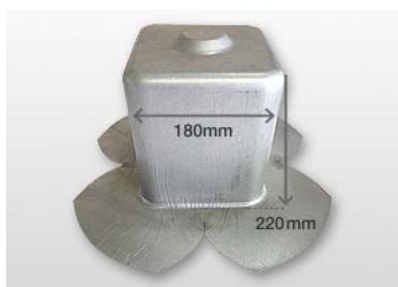
ワーク名称：ケース 加工方法：絞り加工 業 界：家電 材質：MSA40E
