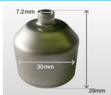
ワーク名称：タンク 加工方法：絞り加工 業界：空調 材質：SUS304
